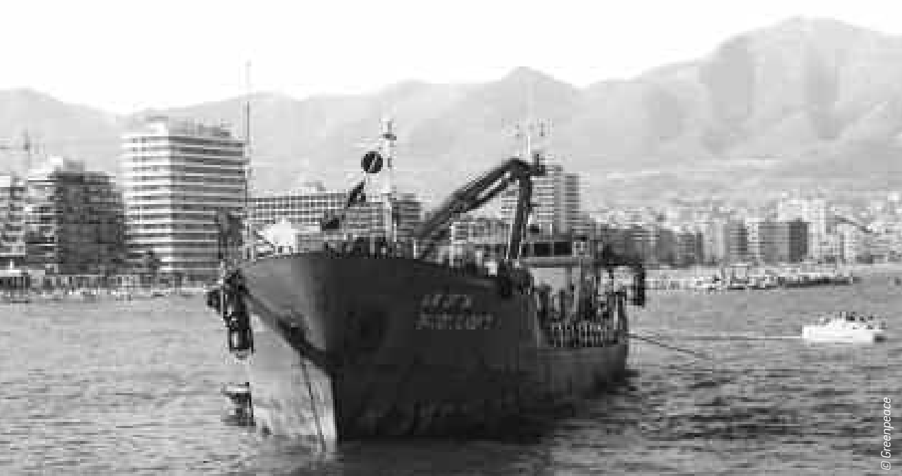
Barco draga empleado para regenerar artificialmente las playas de Málaga.
