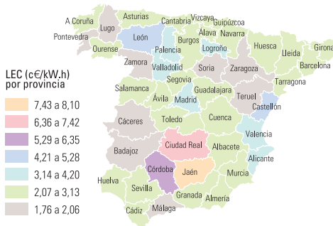
Figura 59 Distribución provincial del LEC eólico en emplazamientos accidentados con la estructura de costes del año 2050. Factor de capacidad evaluado a partir de la serie eólica temporal seleccionada para cada provincia. C_{inv} = 520 \text{ €/kW}_e ; C_{O\&M} = 15 \text{ €/kW}_e\text{-a} ; i = 8\% ; f = 2,6\% ; N = 25 años.
