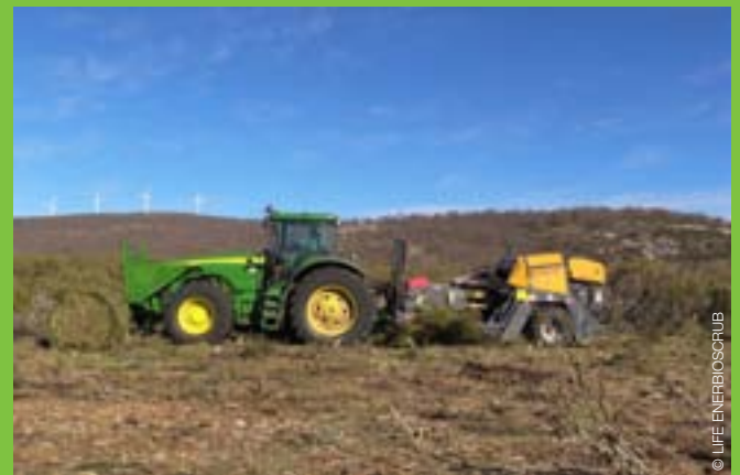
imagen Empacadora de biomasa en pruebas trabajando sobre formaciones forestales ocupadas por matorral de Cytisus ssp , Cistus ssp y Retama ssp en Navas del Marqués (Ávila), dentro del Proyecto Enerbioscrub.
